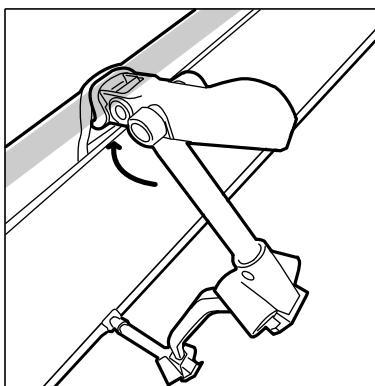
ロックレバー両側面のボタンを押し、レバーを引き起こしてください。その状態でソケットをポールに取り付けてください。
