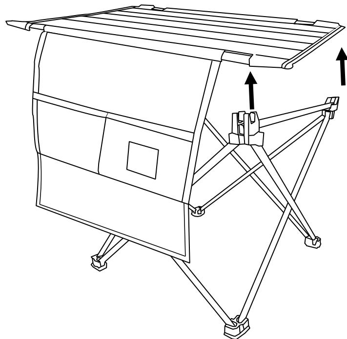
② フレームを折り畳み、テーブル天板の裏面に置きます。
