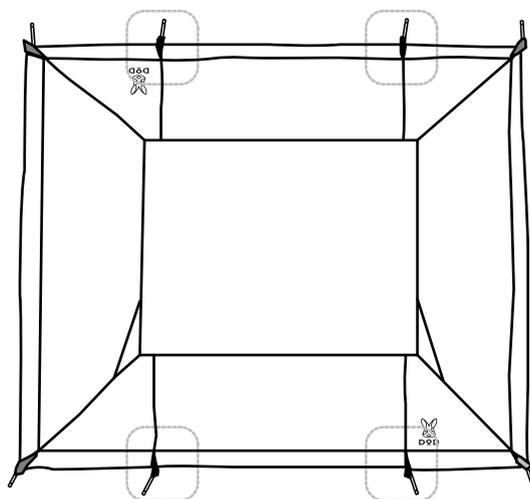
6, テントに付属しているロープをペグで固定し、補強してください。
