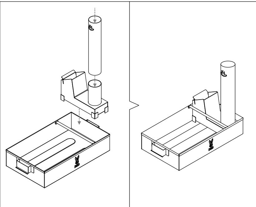
1, 湯船の位置を決め、口ケットストーブと煙突をセットします。
