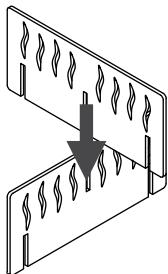
2, ○部分のスリットを煙突上部に差し込みます。
