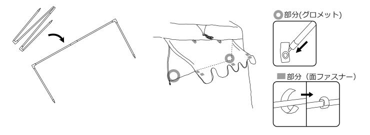
8.必要に応じてフロアをファスナー(**---・**部分)で取り付けて使用してください。 テント本体を固定しているペグにフロアのループ(**コ**部分)を掛けることで、 フロアをより綺麗に張ることができます。
