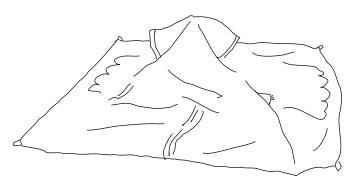
2.ジョイントの中心を持ち上げることで屋根フレームを展開します。 ※ロックがかからない場合は内側からポールを引き伸ばしてロックしてください。
