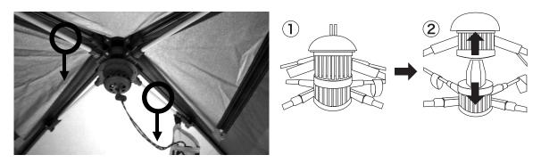
4.屋根フレームのロックを外しフレームを縮めます。
