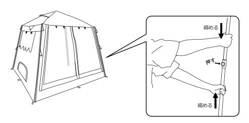
3.ジョイント部分のフレームを両手で握り、下に押し下げます。 下図①→②のように、ジョイント中心部を上下に分割することで、 テント全体が折りたたまれます。
