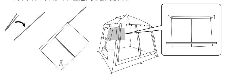
7.窓用ポールを組み立て、サイドウィンドウにポールを設置しロープで固定することで窓を開放することができます。
