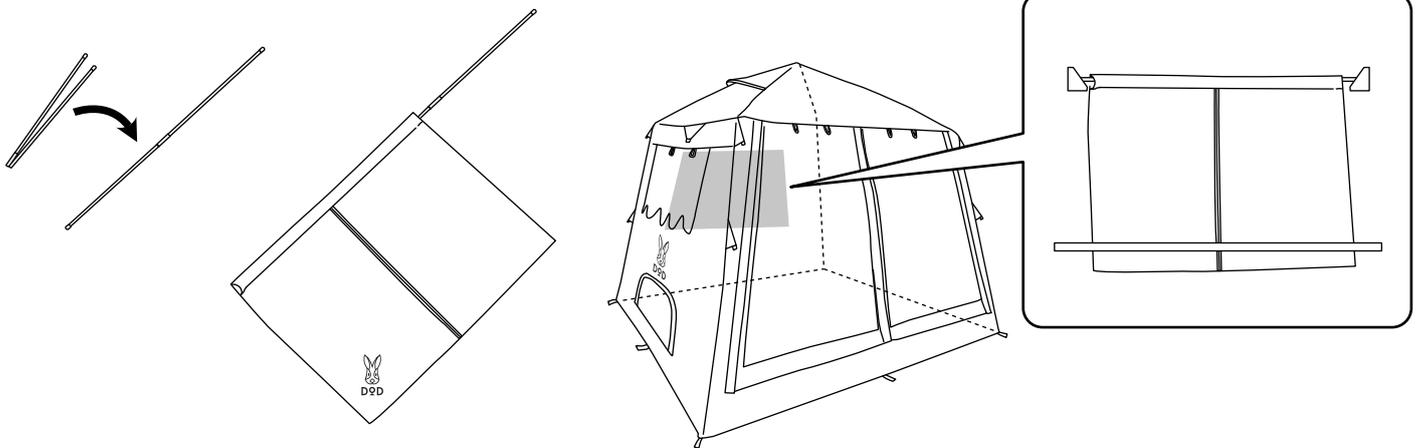
7. 窓用ポールを組み立て、サイドウィンドウにポールを設置しロープで固定することで窓を開放することができます。
