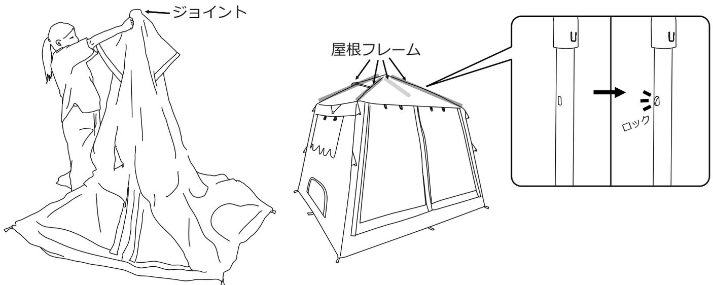
3. テントの中に入り、テント内側からジョイントの中心を片方の手で持ち上げながら、もう片方の手でジョイントロープを下に引き下げます。
