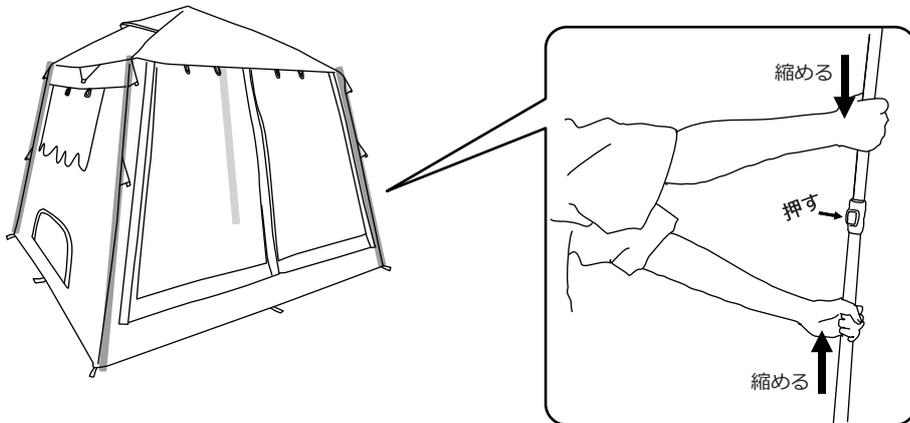
3. ジョイント部分のフレームを両手で握り、下に押し下げます。
