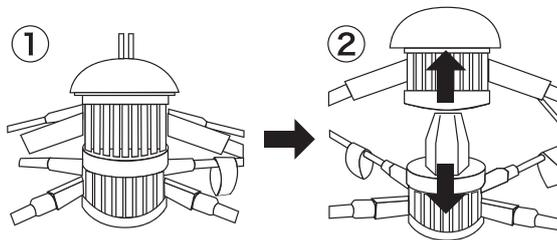
4. 屋根フレームのロックを外しフレームを縮めます。
