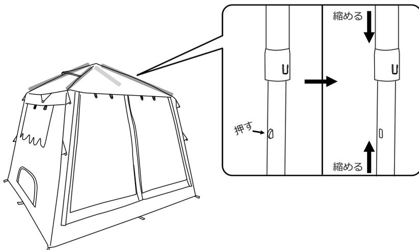
5. フレームの先端をジョイントの中心部分に集まるように折りたたみます。
