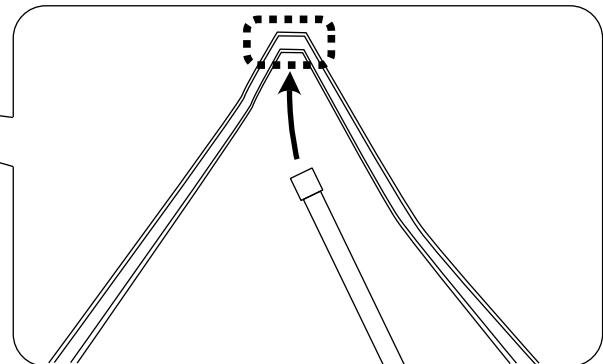
4.2. のX部分のループを調整し、テントの張り具合を調整してください。
