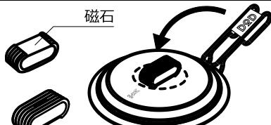
ハンドルの持ち手部分が外れ、シリコンツマミとして蓋の中心に装着させ、蓋の開閉を行えます。
