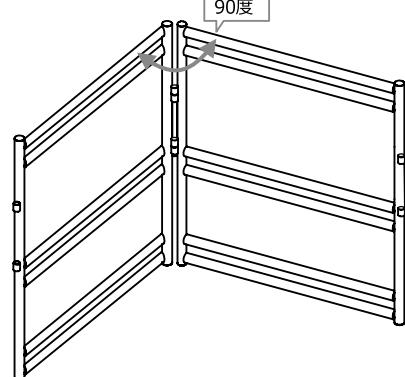
2, 1で組み立てたセットを並べて、レッグの端を合わせ、T型パートを2つ通します。
