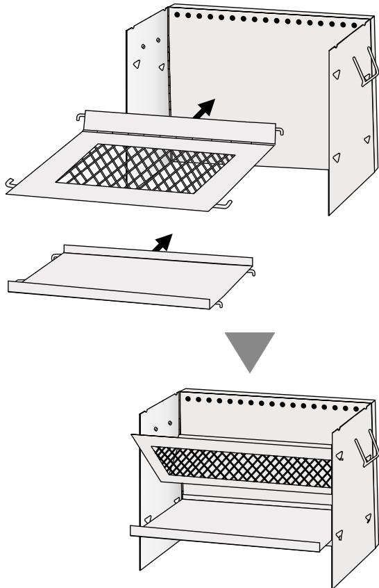
2, 薪受け部と灰受け皿のフックを焚き火台本体の側面にある三角穴にはめ込みます。
