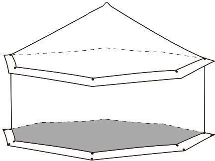
😊 フロア側面のファスナーを開閉することで、フロアを取り外したり、半分だけ土間スペースとして使用することができます。
