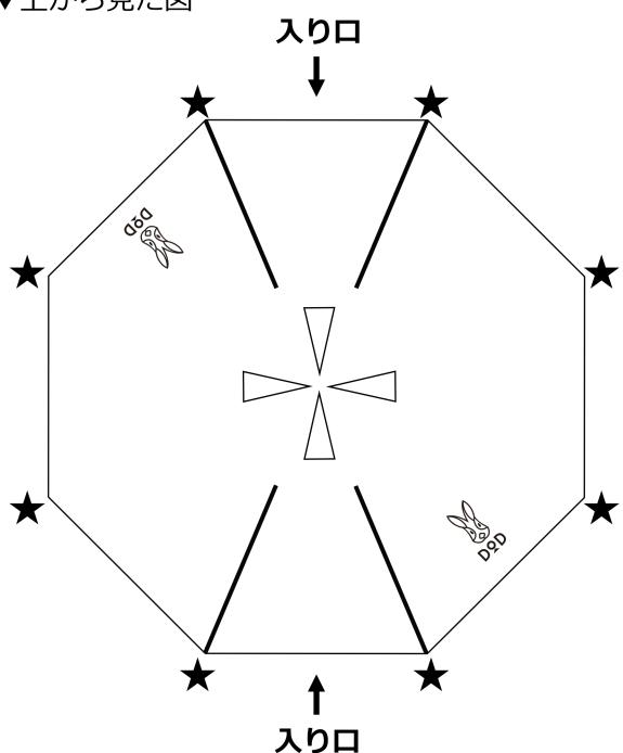
2, トンガリハットをワンポールテントLの中心に配置し、ロープAをテントから離れた位置にペグダウン(★箇所)します。
