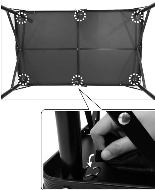
4, 脚部にストレージ棚の面ファスナーをテーブルの各脚に固定します。
