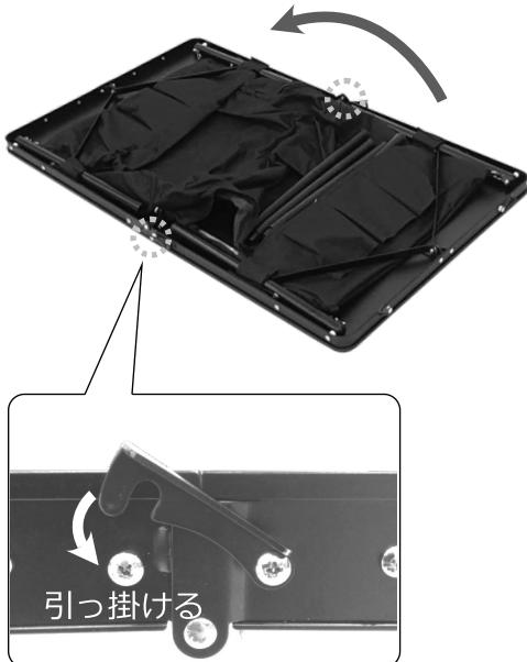
1、テーブルを広げ、側面2箇所のロックレバーで天板を固定します。
