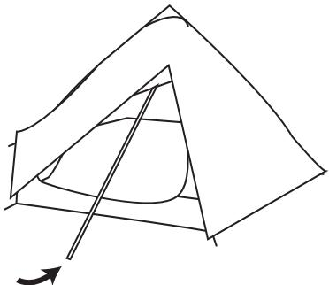
3. ポールを組み立て、インナーテントの中央に差し込みます。ポールが地面に対して垂直になるように立ち上げます。
