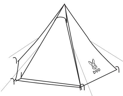
4. ループの長さを調整し、ペグ、ロープを使用しフライシートを確実に固定して完成です。
