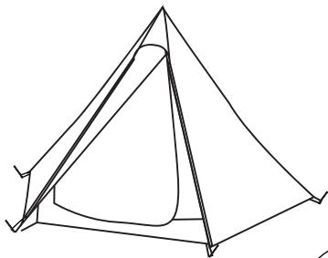
3. フライシートを被せて、インナーテントと同様に角をペグで固定します。各角のベルトの長さを調整し、フライシートの張り具合を調整してください。サイドに付属しているロープをペグで固定すると、より強度や通気性を向上させることができます。
