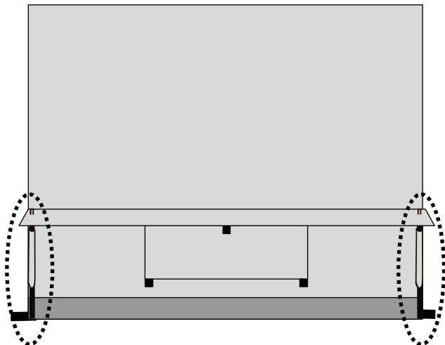
5, ポールを組み立て、ポールの先端が長い方が天井側、短い方が地面側になるように各スリーブにポールを差し込みます。天井側の先端を屋根のグロメットに差し込み、地面側の先端をループのグロメットに差し込み固定します。
