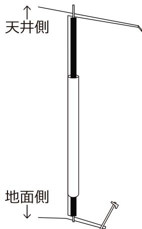
6, 屋根のループにロープを結び、ロープを張り、ペグで固定します。自在でストームロープの長さを調節し、テント生地にシワが寄らないように均等に張ってください。
