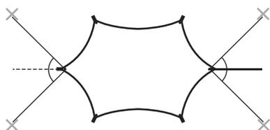
3.上記で決めたロープの先端部分、4箇所に(×部分)にペグを打ち込みます。
