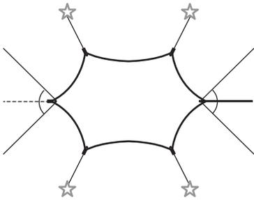
5.ロープの先端部分(☆部分)にペグを打ち込みます。シルバーの自在がついたロープをご使用ください。
