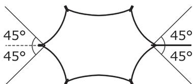
2.ポールを地面に置き、ポールを基準にロープ（長）を45°の角度に配置します。黒色の自在がついたロープをご使用ください。
