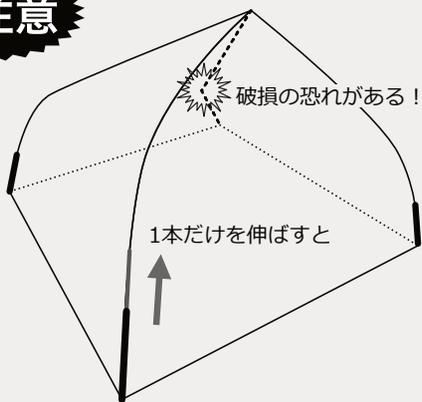
1本だけを先に伸ばした場合、フレームに対して偏った負荷が掛かることで、フレームが倒壊・破損する可能性があります。作業は必ず2人以上で行い、隣り合うフレームを同時に伸ばすようにしてください。
