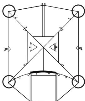
7. インナーテントの四隅に位置するバックルを固定し、インナーテントとフライシートを固定します。
