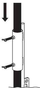
3. ランタンハンガーの先端部分を図のように連結するポールの奥側に沿わせませす。
