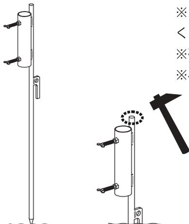
2. ポール差し込み口にポールを差し込みます。蝶ネジを締めてポールをしっかりと固定してください。
