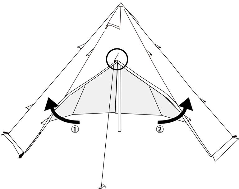
3, 入り口のドア部分2箇所 (①②) を開ける場合、○部分にロープを取り付け、テントがたわまないようにペグで固定してください。
