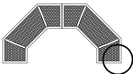
4, 2と同様に右側のプレートをレッグAの中段に差し込んでください。次に3と同様に、プレートの右端にレッグCを差し込み、抜け落ちないようレッグCを傾けてください。
