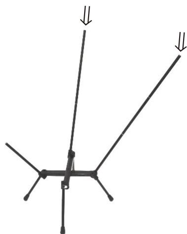
4, フレーム組み立てが完了したら安定した地面に置き、生地の背面側からフレームに差し込みます。
