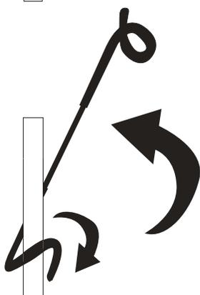
4. ポールを軸としてランタンハンガーを持ち上げ、ひねりながら先端部分をポールにひっかけます。
