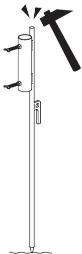
1. ペグのヘッドをハンマーで叩き地面に対して垂直にペグを打ち込みます。
