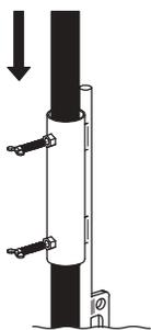
2. ポール差し込み口にポールを差し込みます。蝶ネジを締めてポールをしっかりと固定してください。
