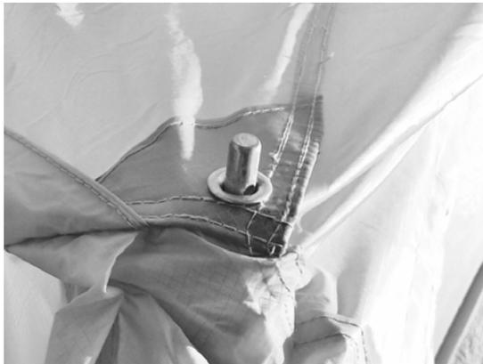
4. テント生地の内側から鳩目にポールの先端を通します。
