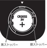
2. 電池をセットします。CR2032の+極側を上にして、1枚ずつ入れてください。この際、黒ストッパー側を先に通すようにして電池を入れてください。※電池を交換する際は、銀ストッパーを右方向に押ししてください。電池の固定が外れますので押しながら裏返し、電池を落とすように外してください。
