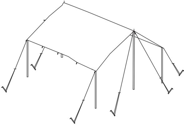
4.タープ生地4隅のグロメットにポールの先端を差し込み、2.3.と同じ要領でポールを固定し完成です。
