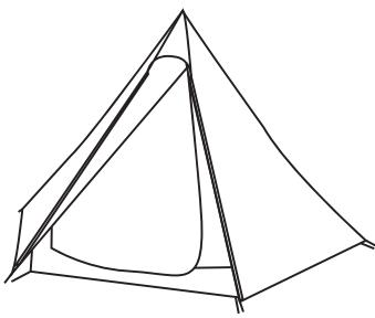
3. フライシートを被せて、インナーテントと同様に角をペグで固定します。サイドに付属しているロープをペグで固定すると、より強度や通気性を向上させることができます。
