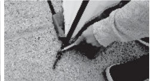
4. ジョイント部についているオレンジ色のパーツを押し込みロックします。パーツがジョイントにしっかりと噛み合えばロック完了です。
