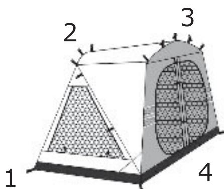
入り口の向きを確認し、インナーテントをテント本体のバックルで留めます。左図のように、寝室の奥から付けていくとスムーズに取り付けができます。インナーテント天井部分で長さを調整して取り付け完了です。
