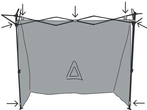
1. タープのフレームの矢印 (→) 部分にアウターテントの面ファスナーを固定します。このとき、アウターテントがタープ生地の下になるように重ねてください。
