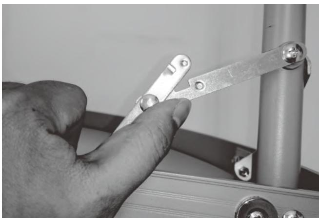
左図を参考に、脚部ストッパーの中心部を押し込んでロックを外してください。
