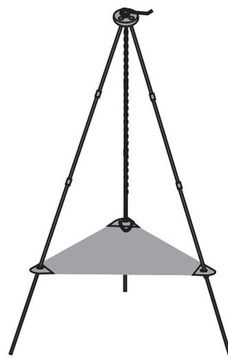
4. チェーン調整用フックを使用することで、吊下げ用フックの位置を調整することができます。チェーンを上引き上げ、チェーン調整用フックをチェーン穴に通して下図のように固定してください。
