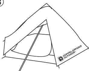
3. ポールを組立て、インナーテントの中央に差し込みます。ポールが地面に対して垂直になるように立ち上げます。
