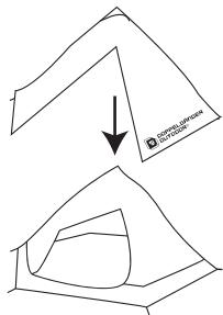
2. フライシートをインナーテントの上に被せます。この時、インナーテントとフライシートの入り口部が同じ面に来るよう フライシートを被せてください。
