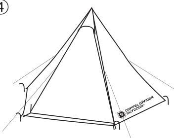
4. ペグ、ストームロープを使用しフライシートを確実に固定して完成です。
