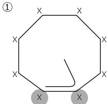
1. インナーテントをキャリーバッグから取り出し、安定した地面へ置きます。コンクリートなどの硬い地面の上へテントを置くと、地面との摩擦により生地が破損することがありますのでご注意ください。インナーテントの各辺ができるだけ引っ張られた状態になるように、左図 X 印 8ヶ所をペグにて固定します。
