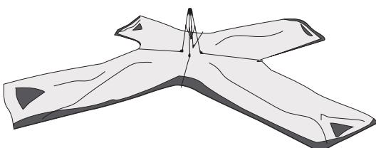
テント本体をキャリーバッグから取り出し、安定した地面へ置きます。コンクリートなどの硬い地面の上へテントを置くと、地面との摩耗により生地が破損することがありますのでご注意ください。折り畳み傘の骨組みを伸ばす要領でテントポール4本を伸ばし、生地を広げます。
