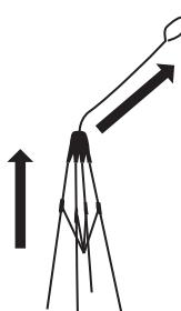
左図のように広げた4辺のポールをロックします。ジョイントを持ち上げ、ジョイント上部から出ているロープを手に持ち、ロープを引き出します。このとき、布地がポールやジョイントに絡まったり、挟まったりしていないことを確認してください。布地が絡まったり挟まったりした状態で無理に組み立てると、布地やポールの破損の原因となります。
