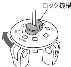
左図のようにジョイント上下が隙間なく結合するまでロープを引き出します。ジョイント上部のロックを時計回りに回し、ジョイントをロックします。
