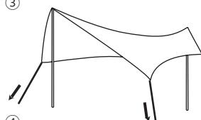
5. センターpoleを立てます。まずは片側のセンターpoleを、地面に垂直に立たせるように起しします。(左図②参照)その後、反対側のセンターpoleも立てます。
