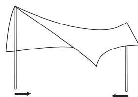
6. 各グロメット(タープの端の丸い穴)に張り縄(短)を通して適度に張り(左図③参照)、ペグを打ち込み固定します。
