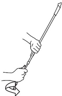
1. 下部ポールを最大まで伸ばします。本体を保持し、もう一方の手で、下部ポールをタングステン（石突）から見て反時計回り（OPEN 表示方向）に回して緩めます。伸ばし切ったら時計回り（CLOSE 表示方向）で締めます。 ※ 目盛上端の「STOP」より長く引き出して使用しないでください。
