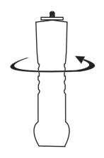
コンパスを外し、左図のようにポール側を回して、頭部のネジにカメラをしっかりと固定してください。 ※カメラを装着したまま、移動しないでください。
