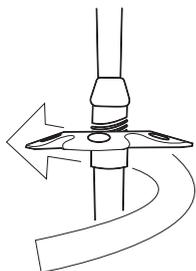
3. スノーシューと一緒にご使用になる場合は、ラバーパッドを取り外し、スノーバスケットをポール下部のネジ部分に装着してください。スノーバスケットはゴム製のため、押しつけるようにしながら、時計回りにねじ込んでください。使用中緩みがないか適宜ご確認ください。
