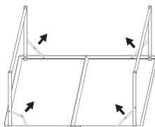
3. 脚部を倒します。4本の脚部それぞれの脚部固定フレームを引き、ロックを外して倒します。
