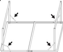
2. 脚部を起こします。4本の脚部それぞれの脚部固定フレームを押し込み、脚部を固定します。
