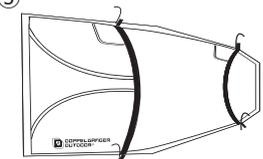
5. エア注入後、バルブのキャップをしっかり締め、ペグでテント側面4ヶ所を地面に固定し完成です。
