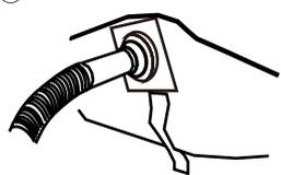
3. エア注入バルブの上段キャップを外し、左図③のようにハンドポンプの先端をエア注入バルブに接続します。
