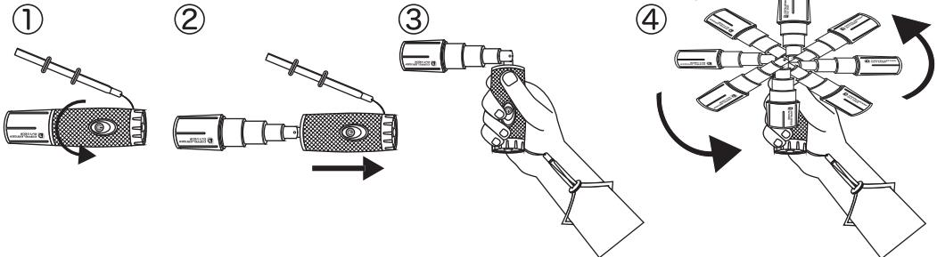
①ラバーグリップ側を反時計回しに回転させるとロックが開放します。
