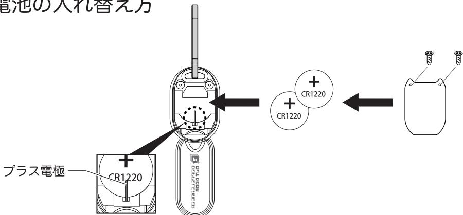
①プラスドライバーを使用し、バッテリーキャップのネジ 2箇所を外します。
