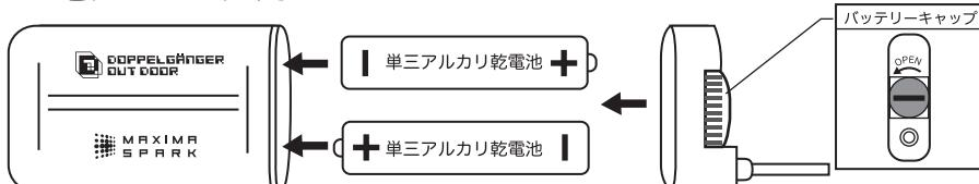
バッテリーキャップを矢印に従って開け、電極の向きに合わせ单三アルカリ乾電池(別売り)2本をセットしてください。
