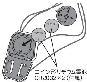
バッテリーキャップを矢印に従って開け、電極の向きに合わせコイン形リチウム電池 CR2032を2個セットしてください。
