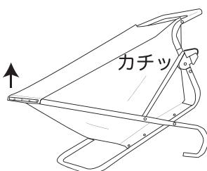
2. リヤカーボン体先端部も上方向に持ち上げます。この時、折りたたみワイヤーのロック機構が、カチッと音が鳴りリヤカーが固定されたことを確認してください。
