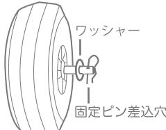
5. ホイールシャフトと固定ピンの間にワッシャーを取り付けて、固定ピンを差込み穴に差込み、ホイールを固定します。
