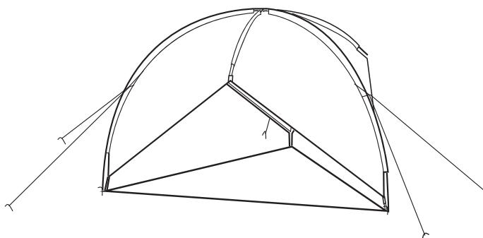
3. ペグ、ストームロープを使用しタープを確実に固定して完成です。
