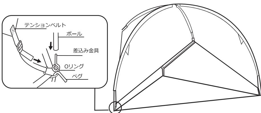
2. 3本のポールをスリーブに通した後、ポールの先端を差込み金具に取り付けタープを立ち上げます。
