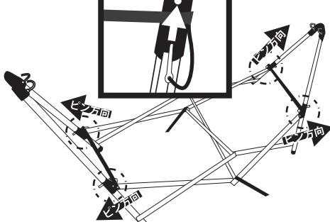
2. 脚部 4箇所のピンをピン穴に通します。この時、脚部のピン穴とジョイント部のピン穴の位置が重なっていることを確認してピンを差し込んでください。また、ピンはスタンドの内側から外側に向けて差し込んでください。脚部のバンドの張力により穴がずれている場合にはひねるようにして穴の位置を調節しながらピンを通してください。
